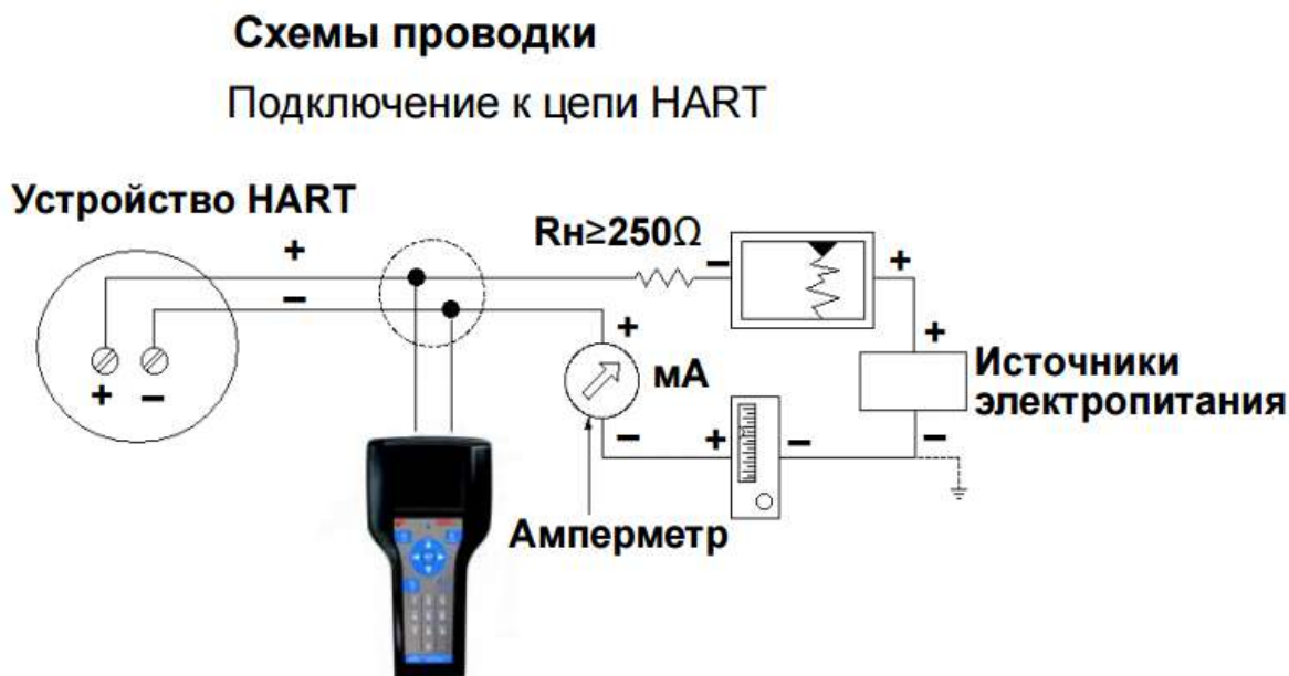
Рис.10. Схема подключения HART-коммуникатора
